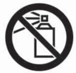
この機器には可燃性スプレーは一切使用しないでください。スプレーには可燃性ガスが入っており、使用すると機械内部に可燃性ガスが残留し、引火・爆発の恐れがあります。
