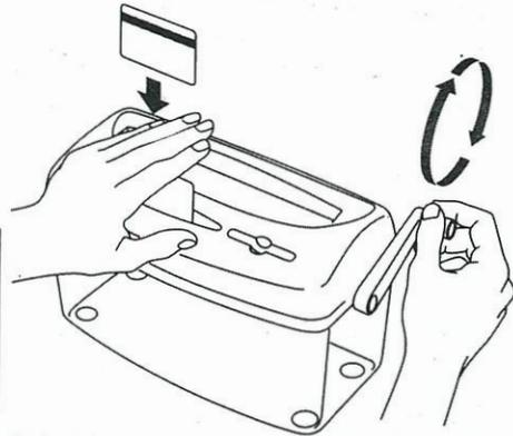
**投入して良いもの** CD、CD-R、CD-RW、DVDなどの12cmディスク1枚。幅57mmまで0.2~0.8mm厚プラスチック製カード1枚。※1
