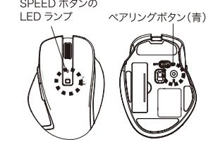
③ 電池を正しく入れた状態で、本製品の底面の電源スイッチを ON にします。
