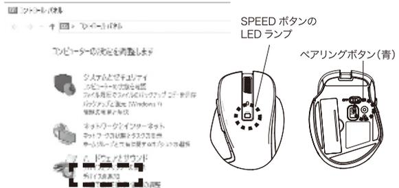
④電池を正しく入れた状態で、本製品の底面の電源スイッチを ON にします。→SPEED ボタンの LED ランプが点灯した後、消えます。
