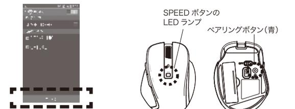
④電池を正しく入れた状態で、本製品の底面の電源スイッチを ON にします。→SPEED ボタンの LED ランプが点滅した後、消えます。
