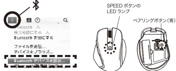
③電池を正しく入れた状態で、本製品の底面の電源スイッチを ON にします。→SPEED ボタンの LED ランプが点灯した後、消えます。
