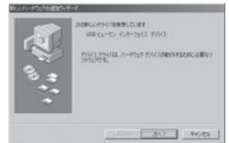
2. インストール時はまだマウスが使用できないため、"次へ"などの操作はキーボードの"Enter"キーや矢印キーを使って操作します。
