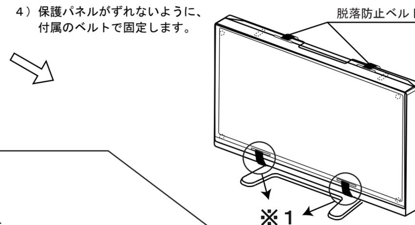
**脱落防止ベルトの取り付け方**
